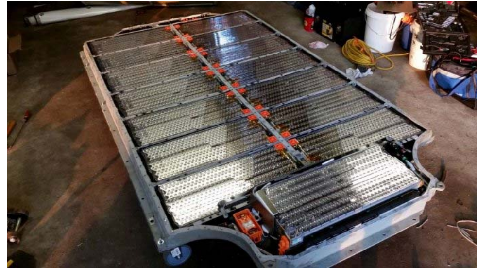
Batterie Tesla de 85 kWh composée de 7 104 éléments
